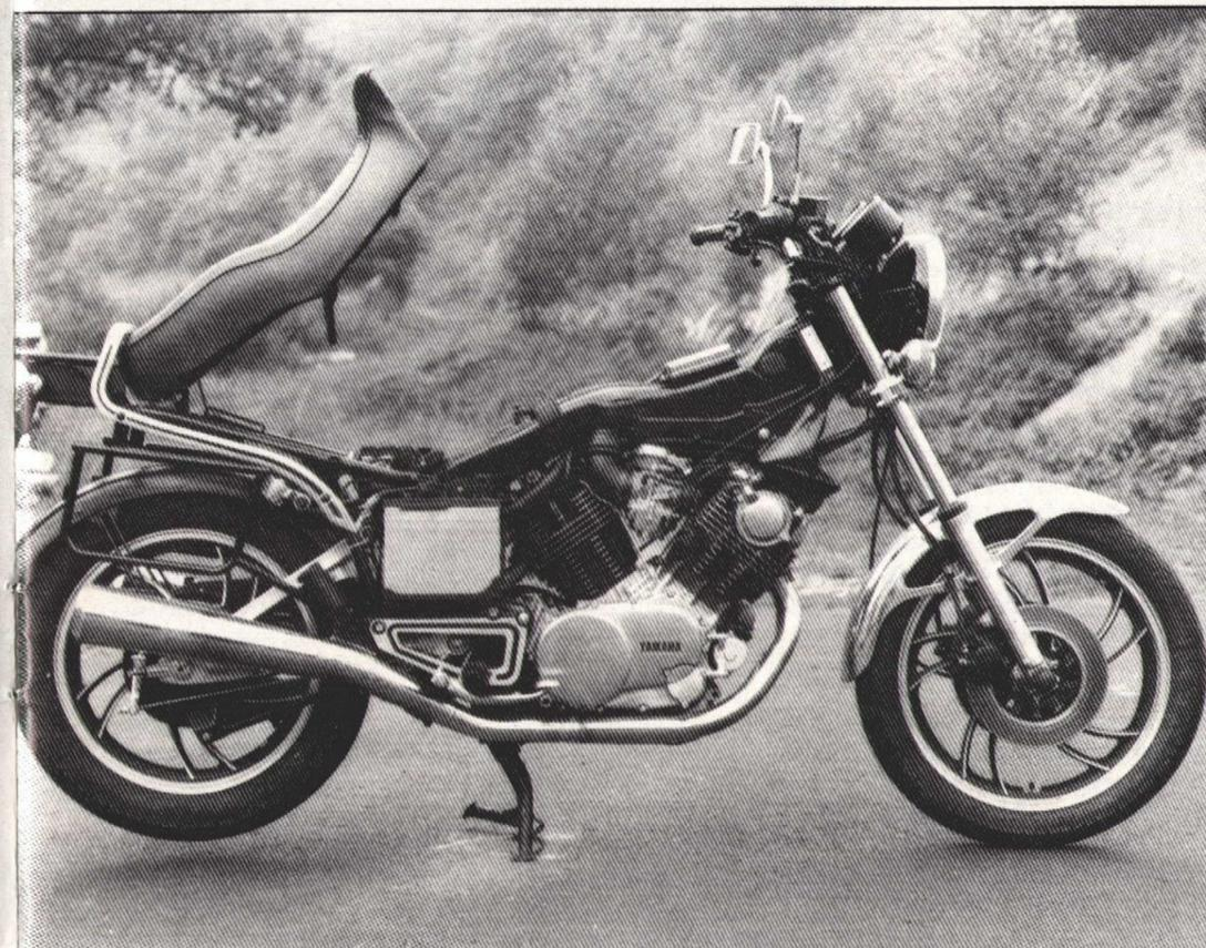
dersystemen einem Modetrend nachgegeben. Welche Tankstelle verfügt schon über genau anzeigende Druckmeßgeräte? Dazu kommt, daß die vorderen Gabelbeine ohne Druckausgleich untereinander sind. Schon ein unterschiedliches Abnehmen des Druckluftschlauches verhindert gleichmäßiges Füllen.
