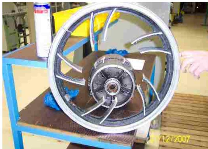
3) Nabe wird auf Innenmaß DT400 Nabe abgedreht.
