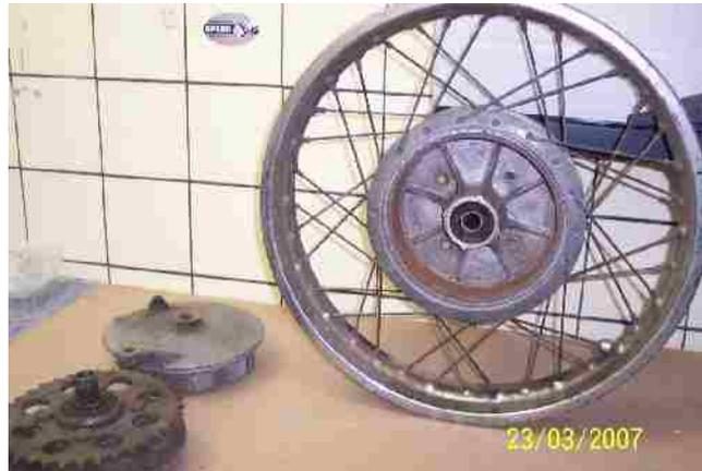
2) Hinterradnabe TR1 wird aus der Felge getrennt, um einen Adapter zu fertigen
