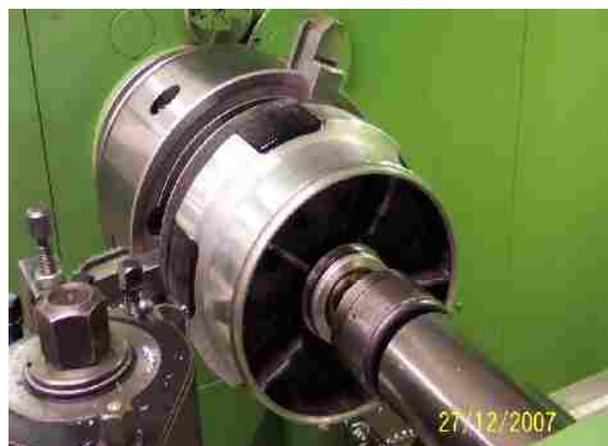
4) Rückseite der TR1 Nabe ohne Trommelbremse. Innere Aufnahme der DT400 Nabe wird auf Maß gedreht.
